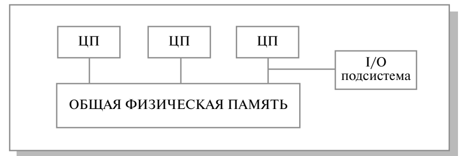
Рис. 3.1. Схематический вид SMP-архитектуры
